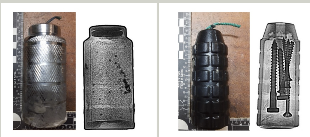
Figuras 3 e 4 : Pedaleira sem metais em seu interior e Pedaleira com metais em seu interior
