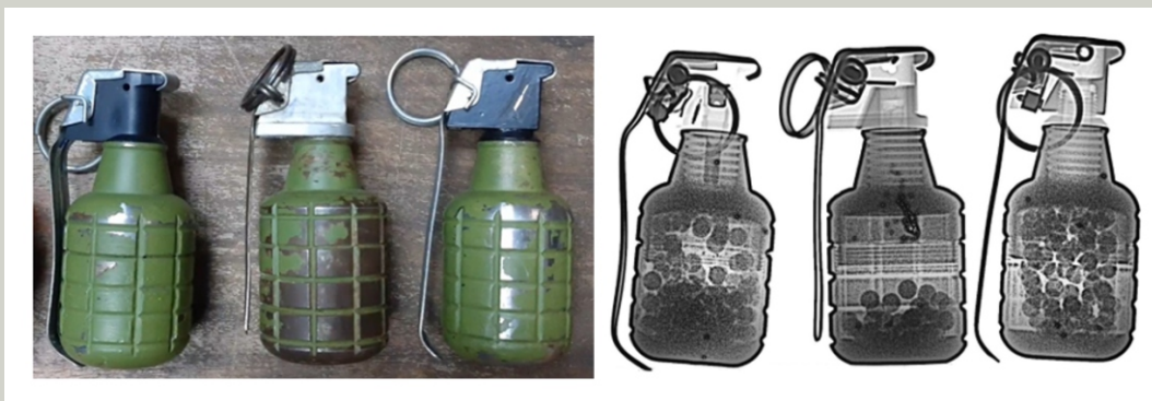
Figura 12: Botijas com diferentes configurações de acionadores e com respectivos raio-x
