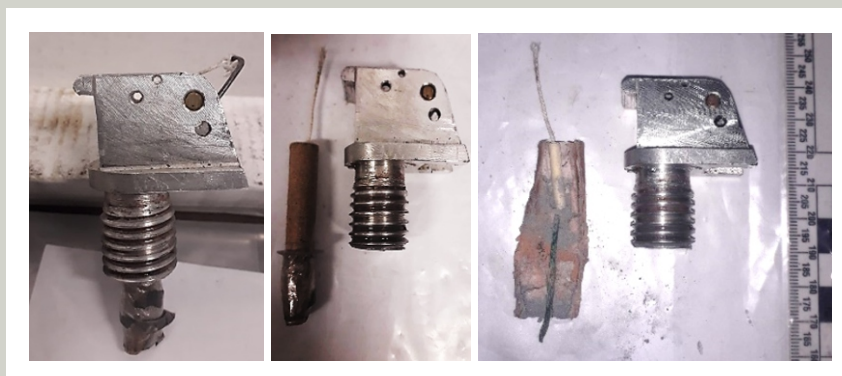
Figura 13 : Sequência de desmontelamento de um mecanismo de acionamento de um IED por tração
