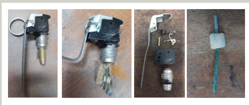
Figura 14 : Sequência de desmantelamento de um mecanismo de acionamento de um IED por tração.
