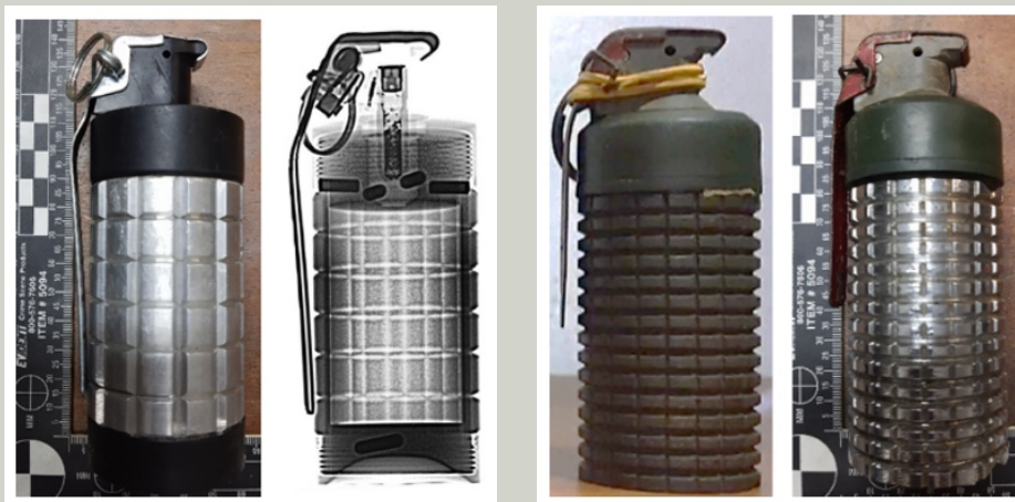
Figuras 15 e 16 : Dispositivo, não original, e, M3 original e com luva pintada. de prata
