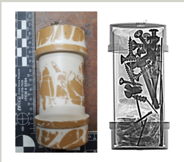
Figura 1 : Bomba tubo de PVC e seu respectivo raio-x
