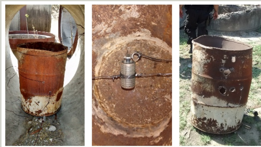
Figura 17 : Teste de fragmentação / estilhaçamento da Dragon
